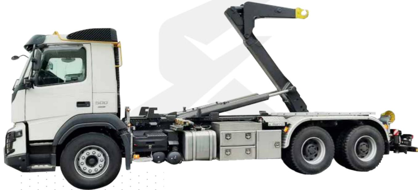
La **potence télescopique et articulée**, associée à la bielette relevable exclusive Marrel, permet d'obtenir un angle de chargement réduit jusqu'à 10° pour une efficacité maximale.
