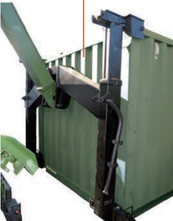
Cadre stocké - twistlock avant H frame stored - Front twistlock
