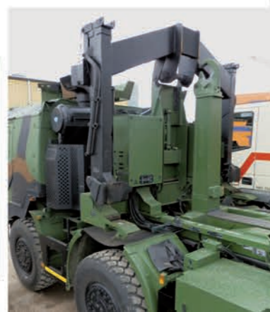
Cadre stocké - twistlock avant H frame stored - Front twistlock
